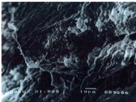
Figura 11: Imagen SEM de la capa de productos de corrosión donde se puede apreciar un ataque menos uniforme y más agresivo, correspondiente a una estación con categoría de corrosividad C4.
