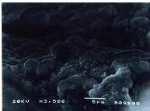
Figura 7: Imagen SEM de los productos de corrosión de una probeta de acero al carbono expuesta durante dos meses en la probeta n° 2.
