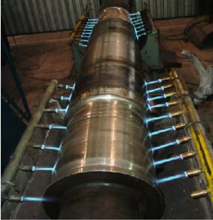
Figura 2. Equipo para calentamiento de ejes con gas natural.
