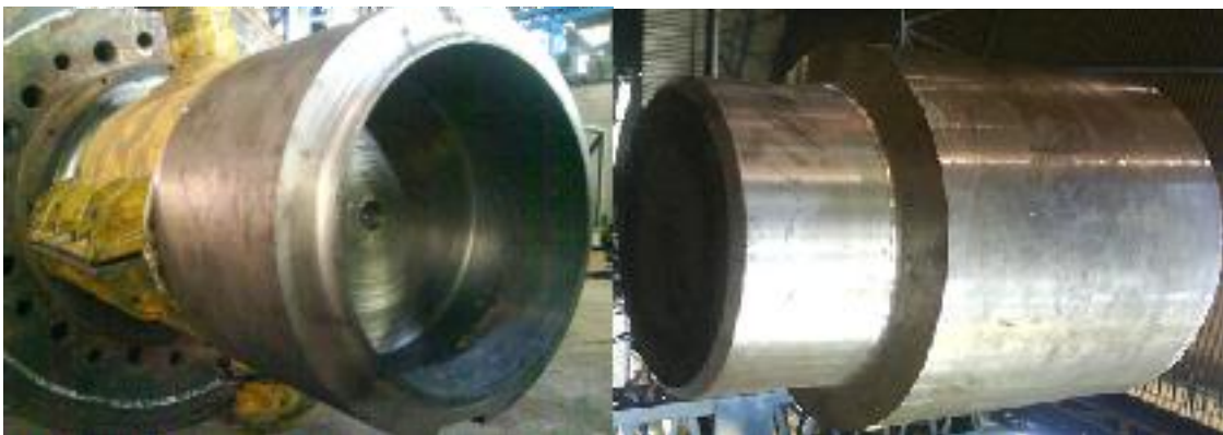
Figura 3. Preparación de eje para embonar cuadrante. A la izquierda agujero hembra, a la derecha inserto macho.
