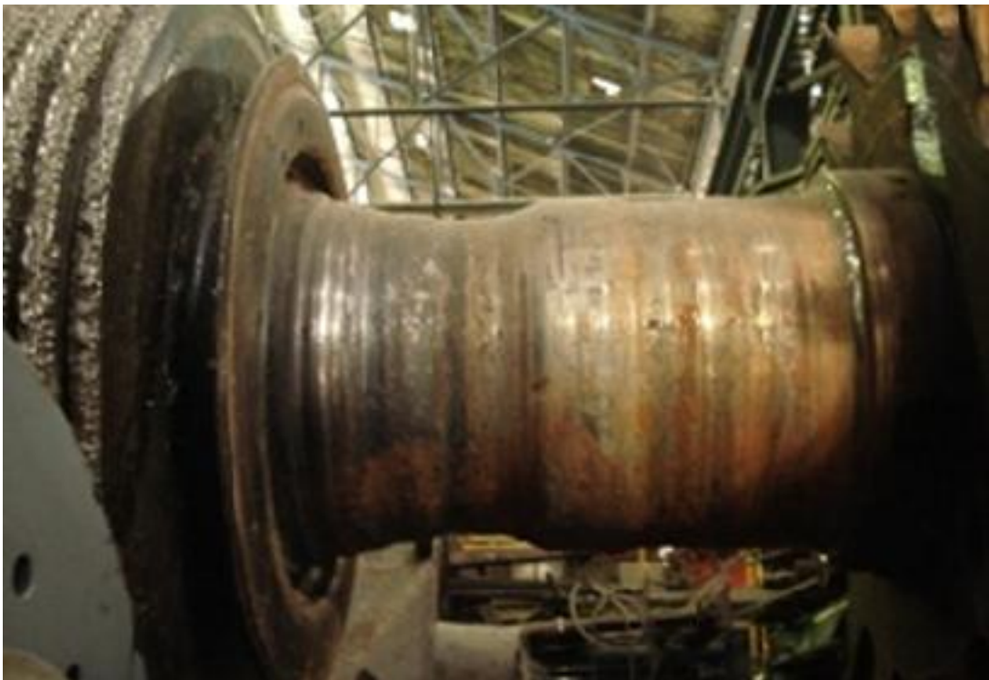
Figura 1. Desgaste severo en un muñón por falta de lubricación.
